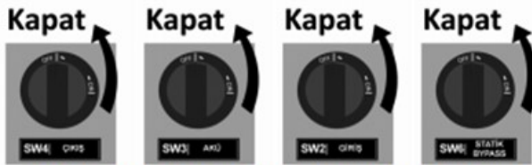
(b) Çıkış (SW4), akü (SW3), giriş (SW2) ve statik bypass (SW6) şalterinin kapatılması
